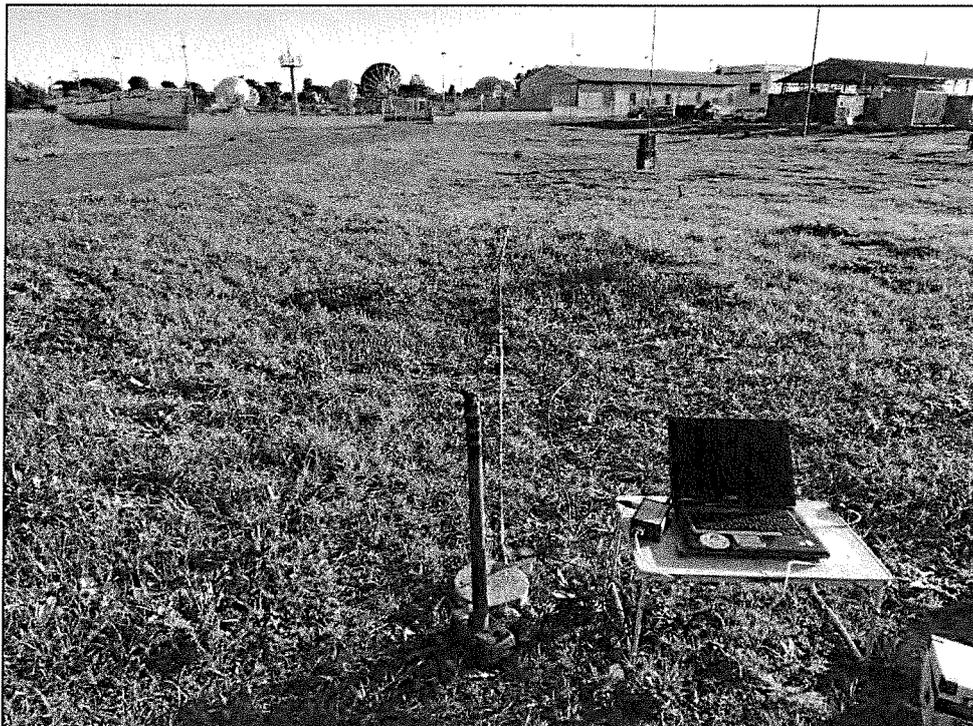
Foto n.2 – Prospezioni geofisiche del tipo sismico eseguite in metodologia MASW-E ReMi con array lineare.
